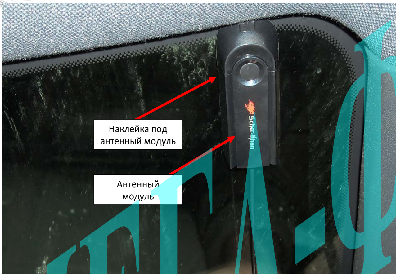
Рис. 9: Возможное место установка антенного модуля.
