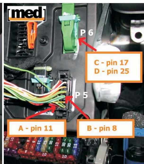
**ЗЕЛЁНЫЙ** 26-ти контактный разъём, обозначенный Р6:
