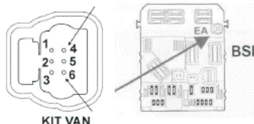
**ПРЕДУПРЕЖДЕНИЕ:** если некоторые провода уже подсоединены к штатному соединителю, подсоединяйте провода параллельно к ним. Мы рекомендуем использовать комплект KIT VAN, поставляемый компанией med, в который входит штатный соединитель с предварительно смонтированной проводкой.
