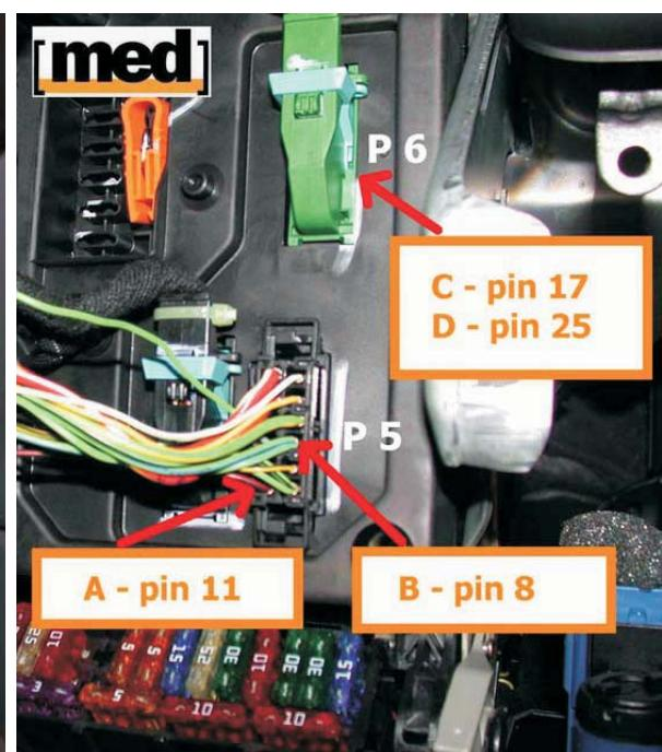
На ЗЕЛЁНОМ 26-ти контактном разъёме, обозначенным Р6.
