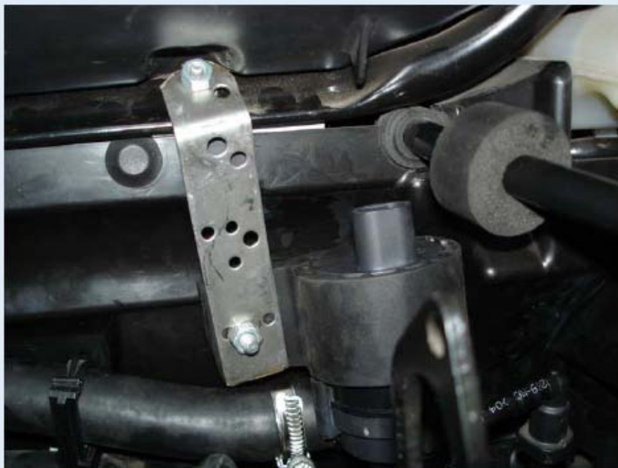
Закрепить кронштейн водяного насоса гайками М6
