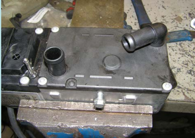
Замена входного патрубка отопителя
