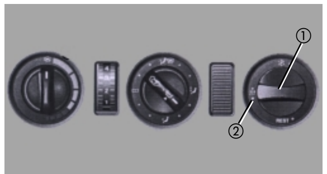
① Schalter, Zuheiz - Schalter drücken ② Kontrollleuchte und Heizungssymbol
