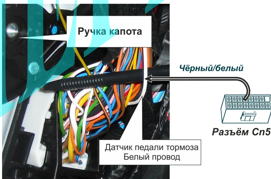
Рис. 6. Подключение к проводу датчика педали тормоза.
