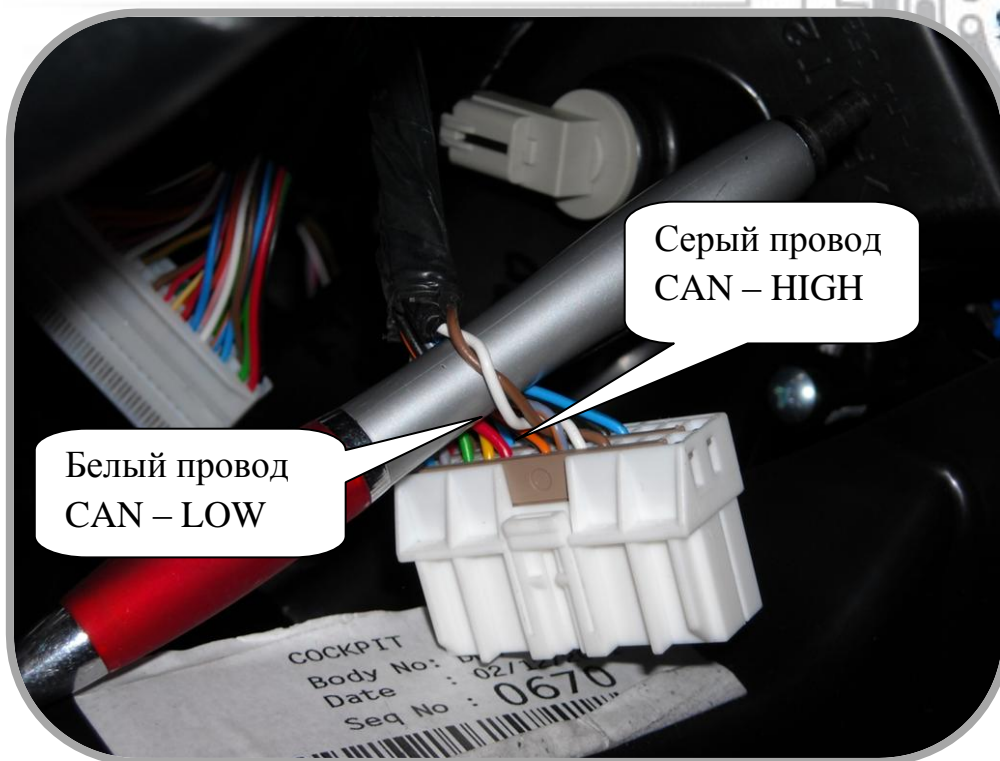
Рис. 2 Провода шины CAN
