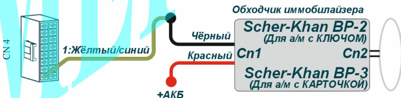
Схема. 7: Подключение обходчика иммобилайзера.
