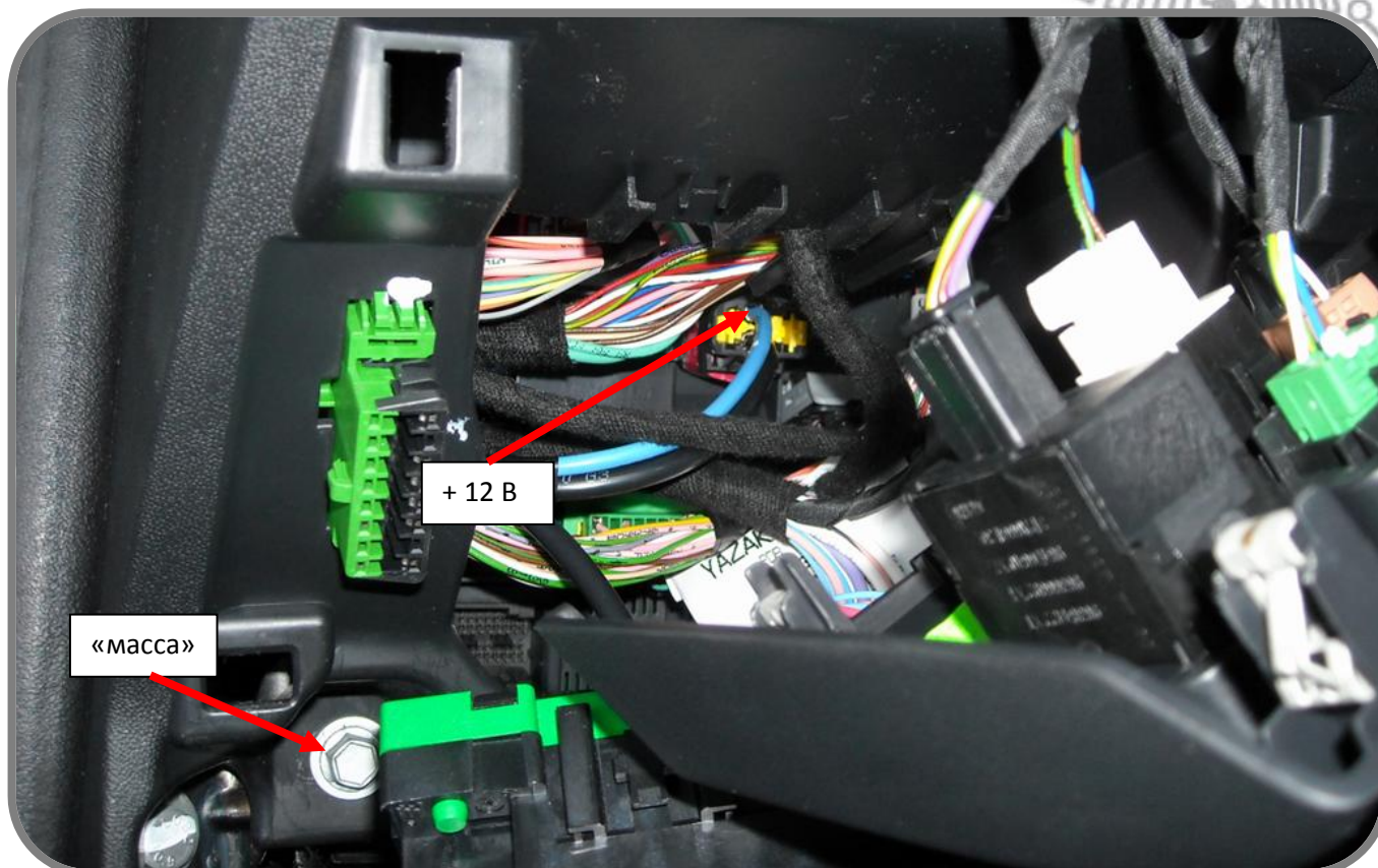
Рис. 14: Подключение питания и «массы».
