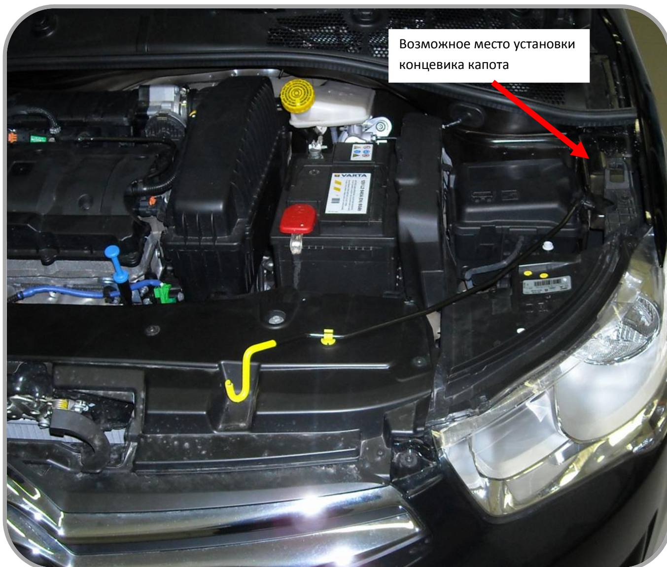
Рис. 8: Возможное место установки датчика капота.
