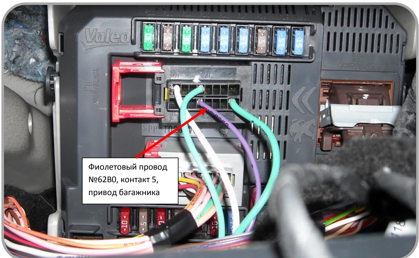
Рис. 7: Подключение отпирания багажника.
