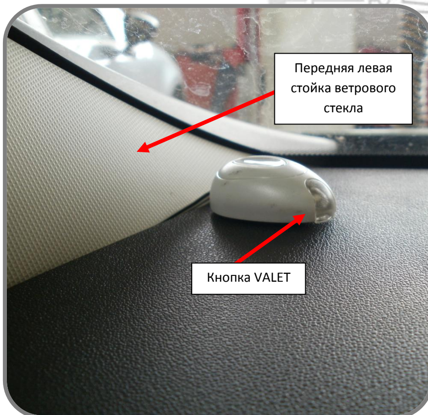
Рис. 12: Возможное место установки кнопки VALET и СИД.
