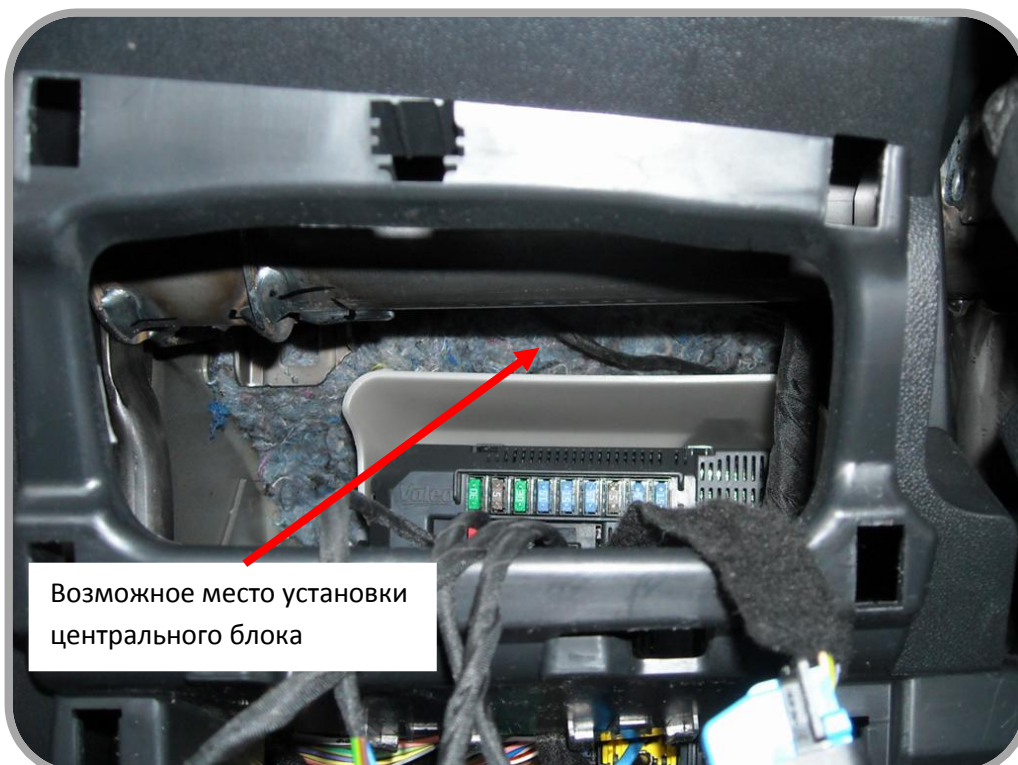
Рис. 13: Возможное место установки центрального блока.
