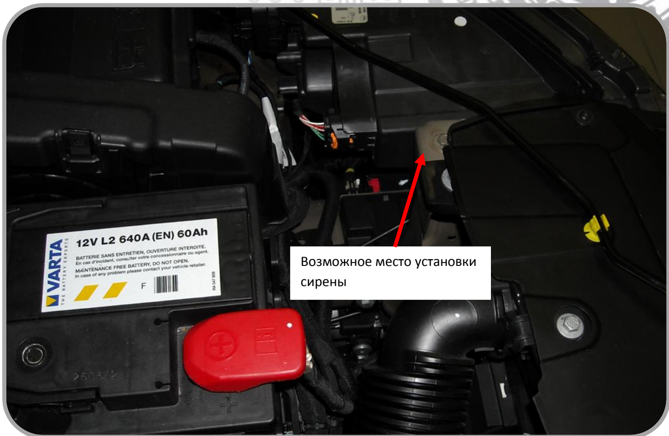
Рис. 9: Возможное место установки сирены.
