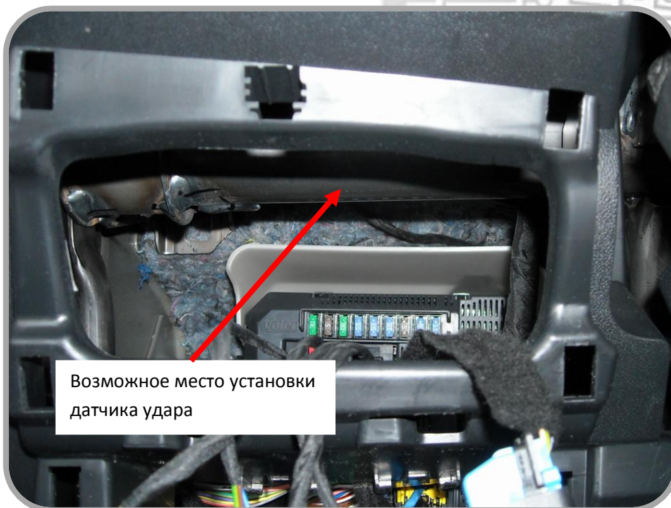
Рис. 10: Возможное место установки датчика удара.
