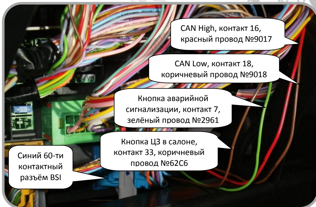
Рис. 2: Подключения к CAN шине BODY, аварийной сигнализации и управлению закрытием ЦЗ по кнопке.
