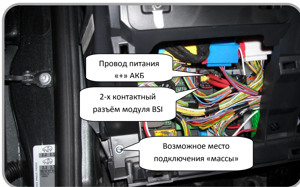
Рис. 11: Подключение питания и «массы».
