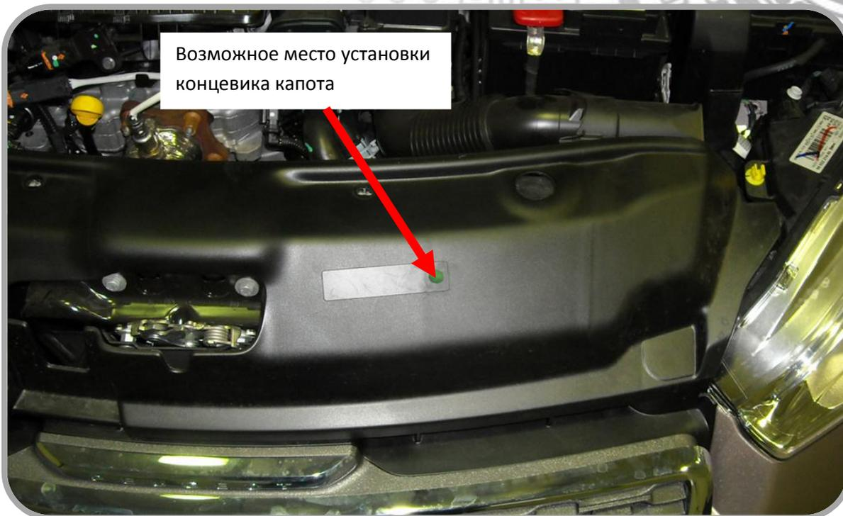
Рис. 9: Возможное место установки датчика капота.
