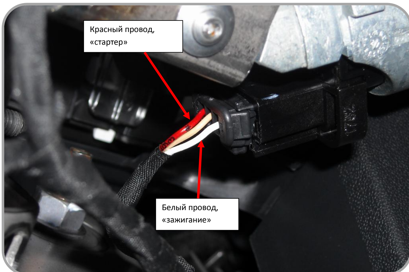
Рис. 4: Подключение цепей автозапуска.
