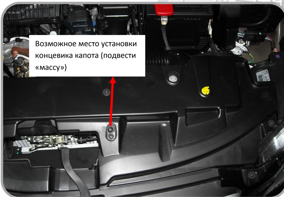
Рис. 9: Возможное место установки датчика капота.
