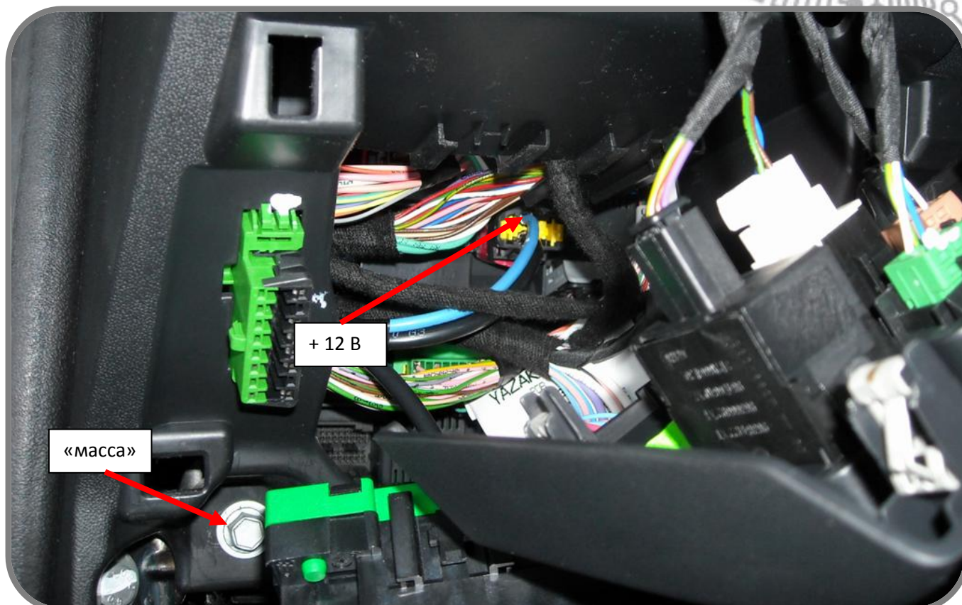
Рис. 15: Подключение питания и «массы».
