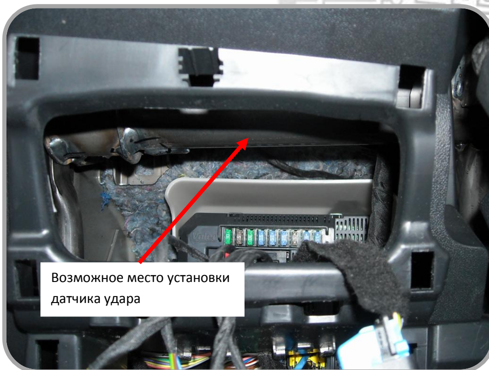
Рис. 11: Возможное место установки датчика удара.
