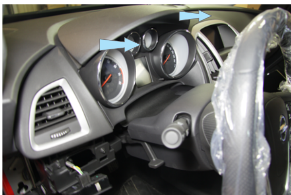
Фото 3.3. Снятие козырька приборной панели
