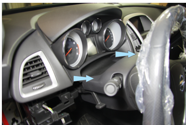
Фото 3.1. Снятие нижней накладки приборной панели
