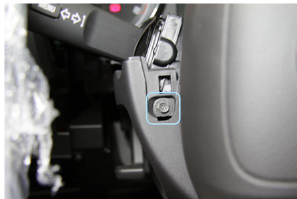
Фото 2.4. Крепление рулевого кожуха со стороны руля
