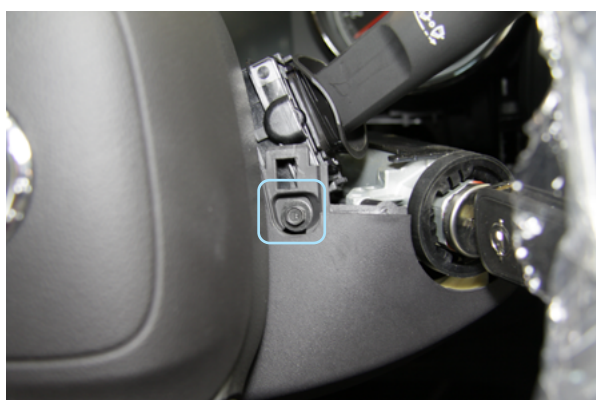
Фото 2.5. Крепление рулевого кожуха со стороны руля
