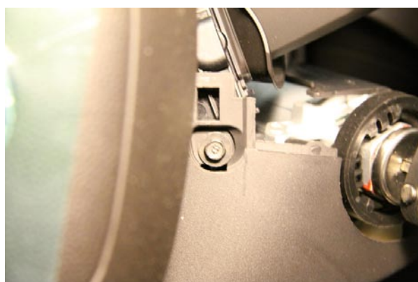
Фото 2.1. Снятие верхней части кожуха и один из саморезов крепления нижней части
