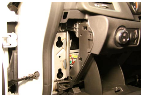
Фото 1.1. Снятие боковой накладки
