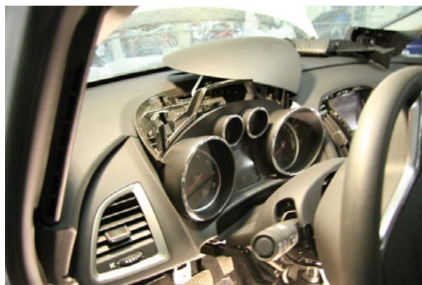
Фото 4.3. Снятие верхней накладки
