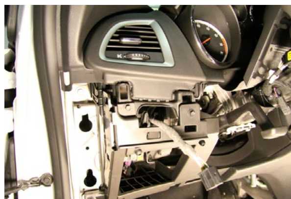
Фото 1.2. Снятие левой половины подторпедника
