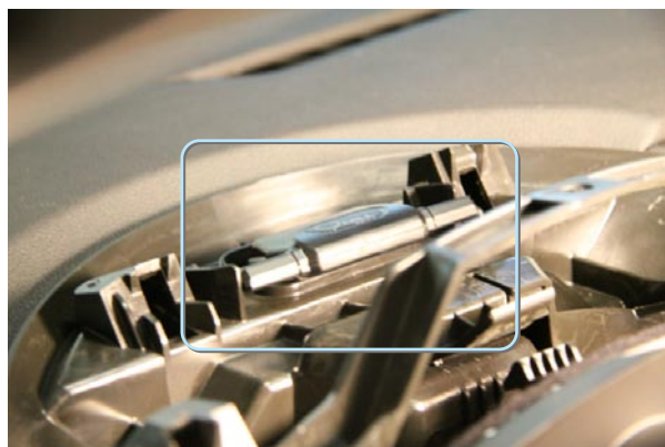
Фото 7.3. Антенна за приборным щитком
