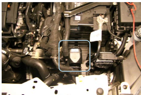
Фото 5.1. Сирена (крепление на 2 самореза)
