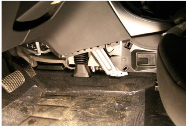
Фото 3.1. Снятие левой накладки
