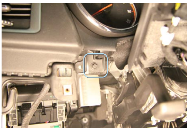
Фото 4.1. Крепление приборного щитка
