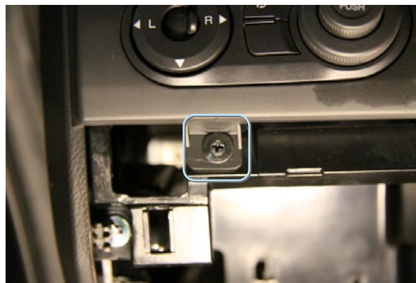
Фото 3.2. Крепление левой накладки
