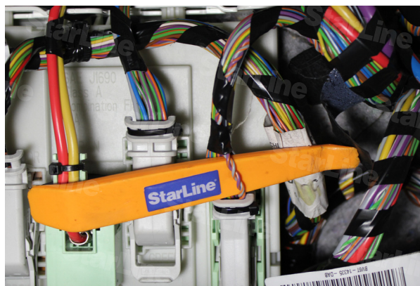
Фото 9. CAN-шина (CAN-H серо-оранжевый; CAN-L фиолетово-оранжевый)
