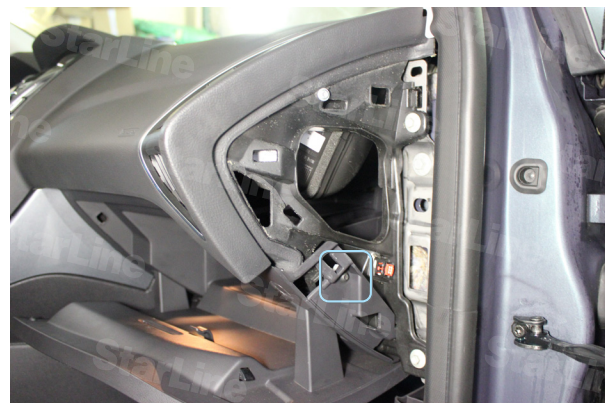
Фото 3.2. Накладка торпеды снята, саморез
