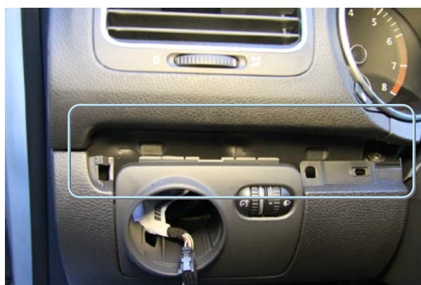
Фото 1.3. Снятие декоративной накладки
