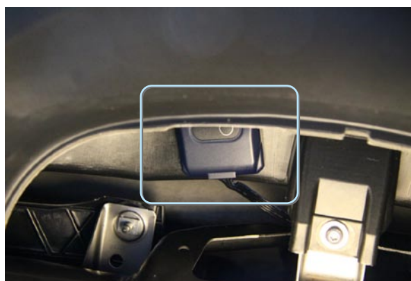
Фото 5.4. Антенна за приборным щитком
