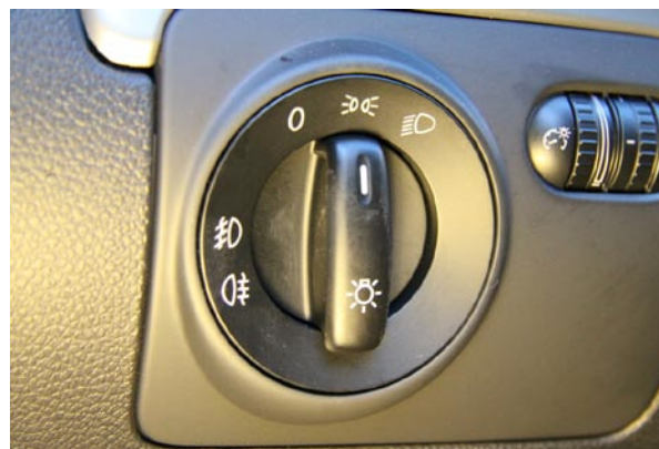
Фото 1.2. Снятие переключателя света
