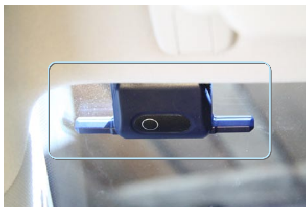
Фото 5.3. Антенна на лобовом стекле
