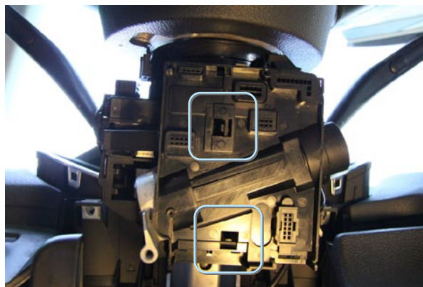
Фото 11.4. Крепление верхней части корпуса
