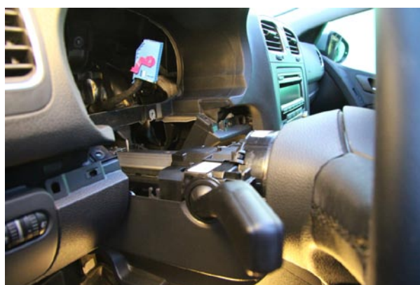
Фото 2.1. Снятие верхней половины облицовки
