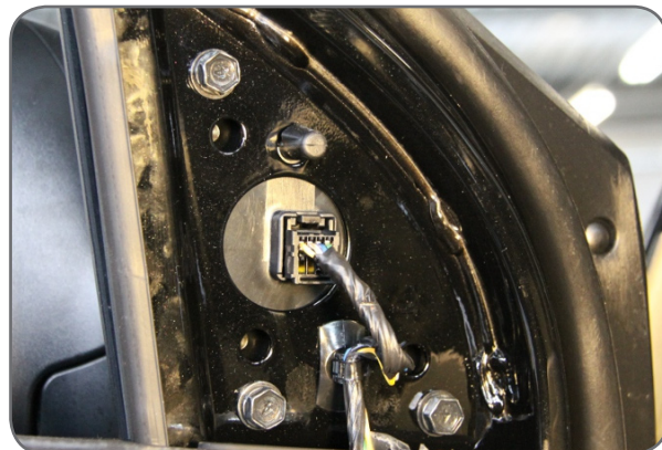
Фото 15.2. Снятие «уголка» двери
