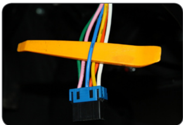
Фото 12.5. Постоянный плюс (синий)
