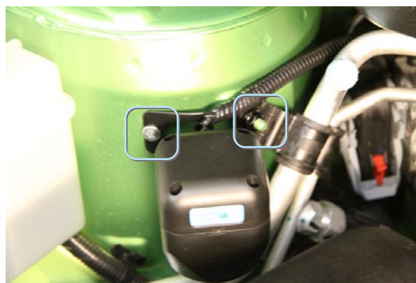
Фото 5.2. Сирена. Крепление на гайку М6 и саморез
