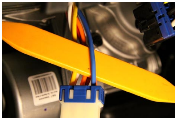
Фото 16.1. Зажигание1 (IGN1 — синий)
