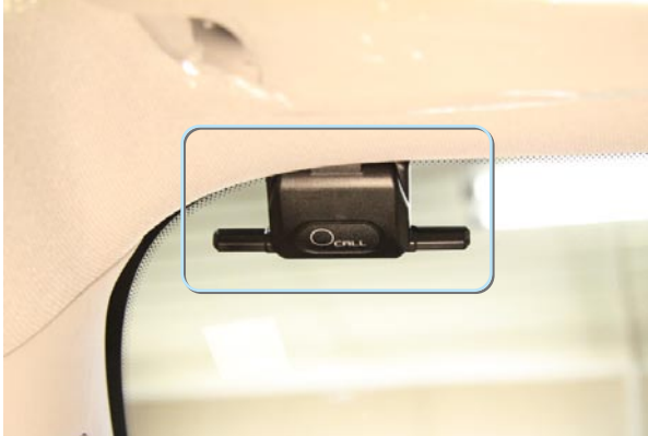
Фото 5.3. Антенна на лобовом стекле
