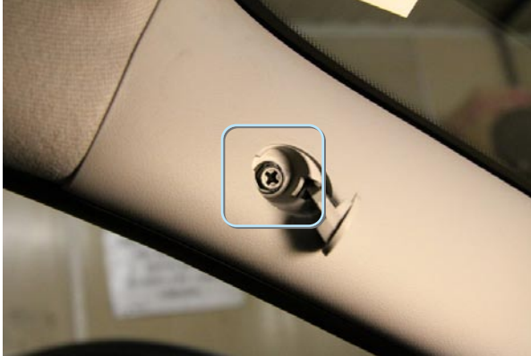
Фото 5.1. Крепление стойки лобового стекла
