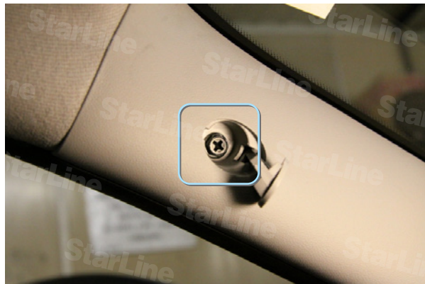
Фото 5.1. Крепление стойки лобового стекла
