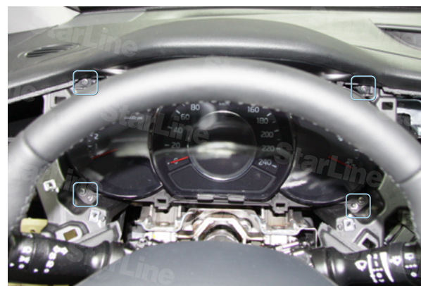
Фото 3.7. Накладки сняты, саморезы щитка приборов
