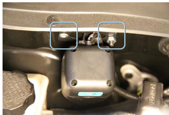
Фото 5.2. Сирена. Крепление гайкой М6 и саморезом
