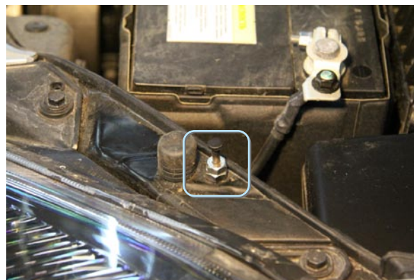
Фото 5.4. Концевик капота. Высота 27 мм.
