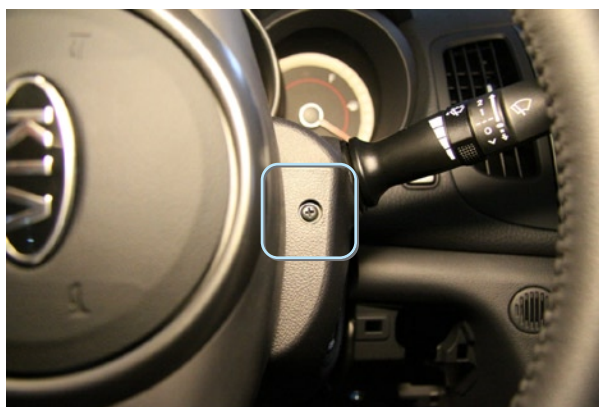
Фото 2.3. Саморез крепления облицовки
