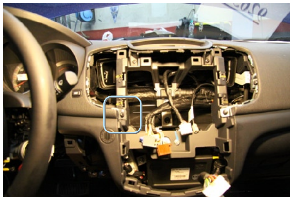
Фото 3.4. Третий саморез крепления накладки приборного щитка
