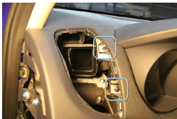
Фото 3.1. Два самореза крепления накладки приборного щитка
