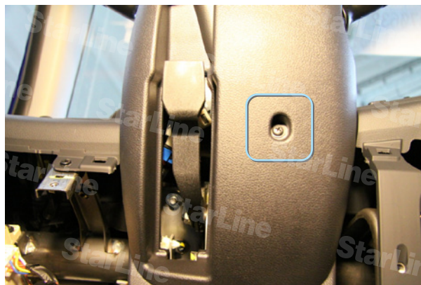
Фото 2.1. Саморез крепления облицовки
