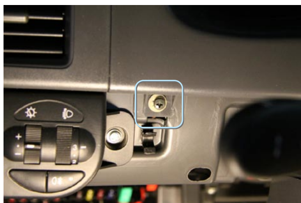
Фото 1.5. Крепление облицовки приборного щитка
