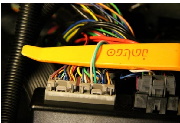
Фото 17. Провода рамки штатного иммобилайзера (белый, зеленый)
