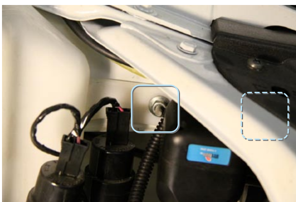
Фото 5.2. Сирена. Крепление гайкой М6 и саморезом
