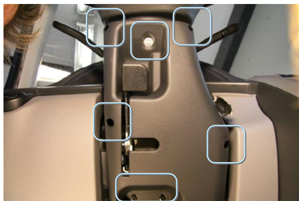
Фото 1.3. Крепление облицовки рулевого вала
