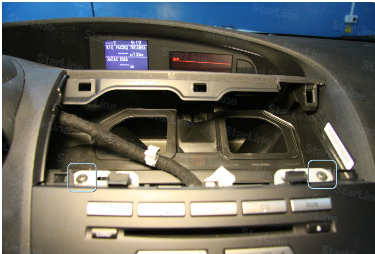
Фото 5.1. Снятие воздуховодов и крепление магнитолы
