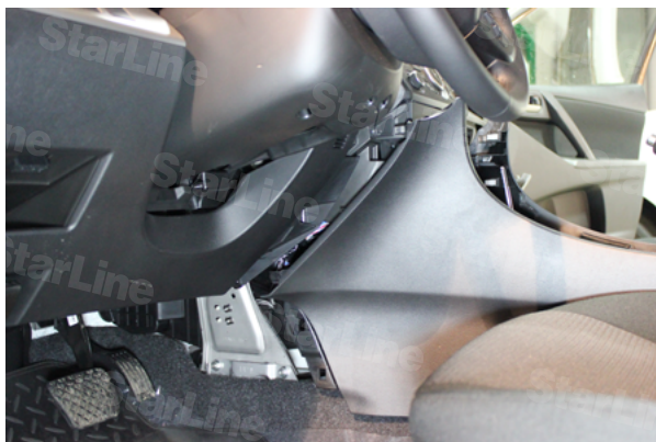
Фото 2.11. Тоннель сдвинут назад
