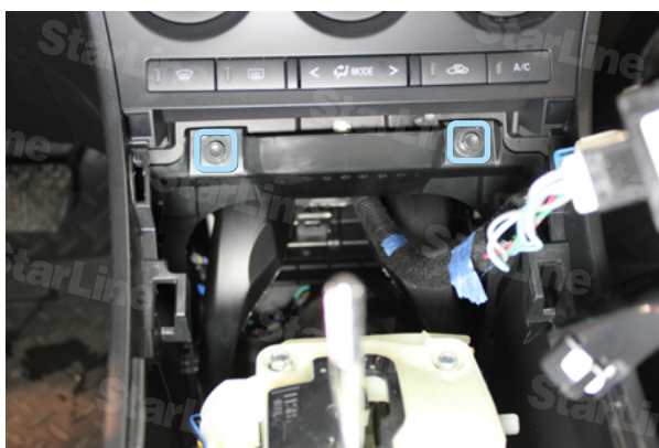
Фото 2.5. Болты крепления центрального тоннеля
