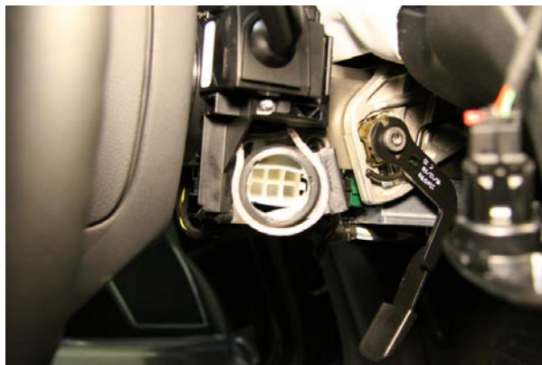
Фото 9. Рамка модуля обхода штатного иммобилайзера
