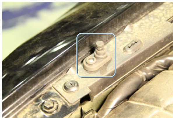
Фото 6.2. Концевик капота (отрезать 2,5 деления)
