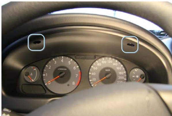
Фото 2.1. Крепление облицовки приборного щитка
