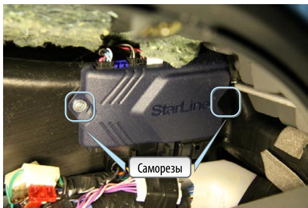
Фото 6. Крепление блока сигнализации
