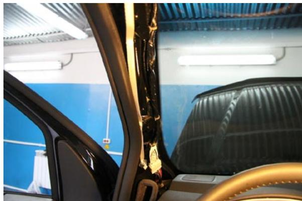
Фото 3.1. Снятие стойки лобового стекла
