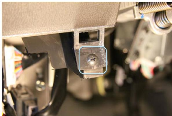
Фото 3.2. Саморез крепления облицовки
