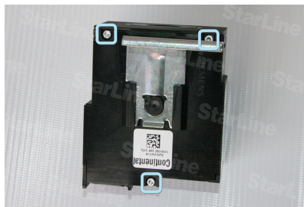
Фото 9.2. Саморезы крышки слота ключа
