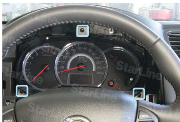
Фото 2.7. Саморезы крепления панели приборов
