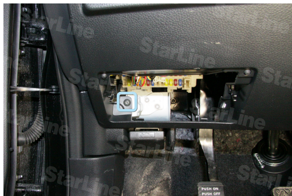
Фото 1.2. Боковая накладка торпеды снята
