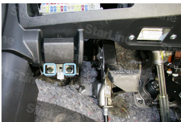
Фото 1.3. Болты крепления ручки открывания капота
