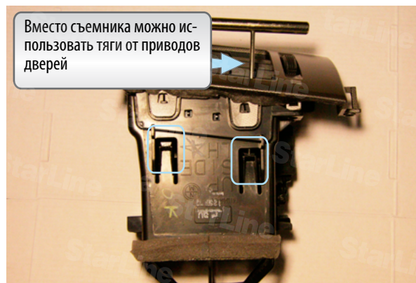
Фото 1.4. Верхние защелки накладки воздуховода
