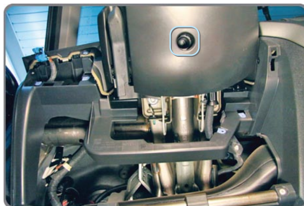
Фото 2.4. Крепление нижней части облицовки
