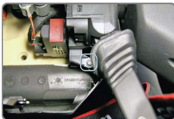
Фото 2.6. Крепление нижней части облицовки
