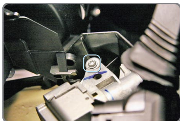
Фото 2.5. Крепление нижней части облицовки
