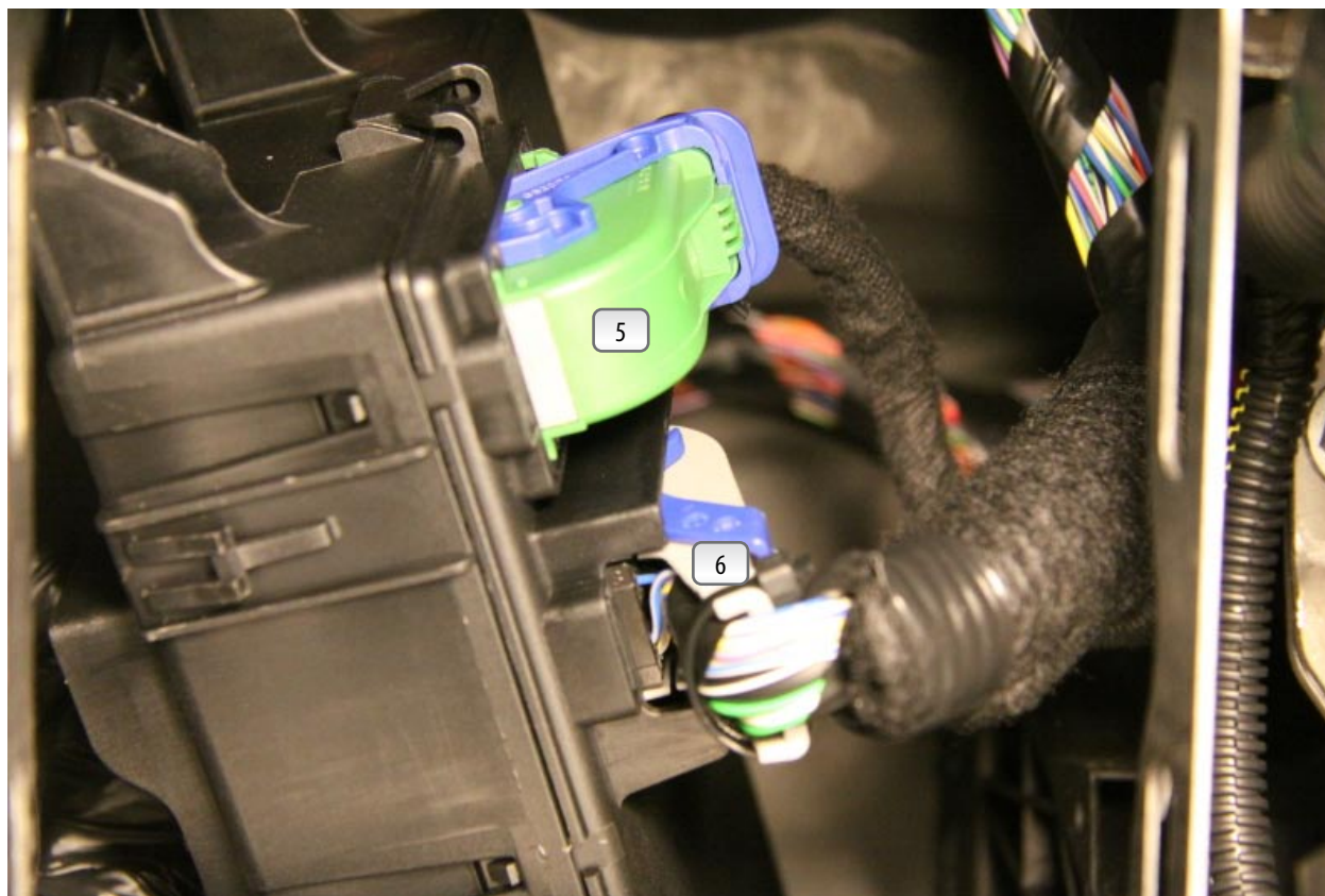
Фото 3.4. Нумерация разъемов с обратной стороны блока BCM
