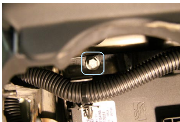
Фото 3.2. Верхний болт крепления блока ВСМ
