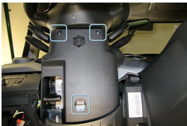
Фото 1.7. Нижнее крепление рулевого кожуха
