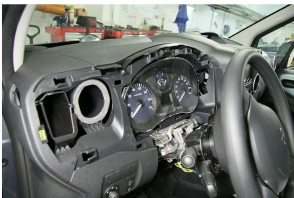
Фото 1.9. Накладка панели приборов снята
