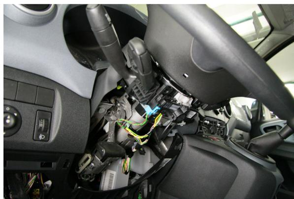
Фото 1.8. Рулевой кожух снят
