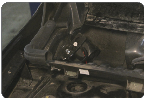
Фото 4.1. Сирена (крепление болтом и гайкой М6)
