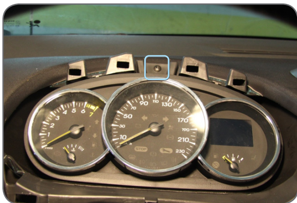
Фото 2. Крепление приборного щитка
