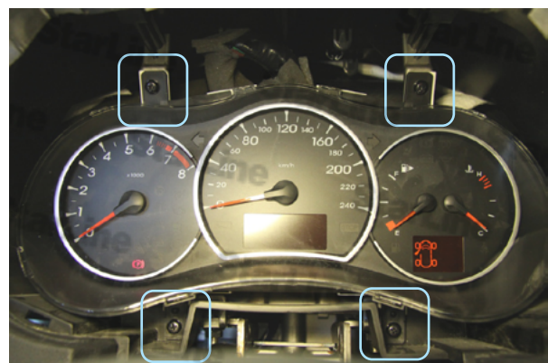
Фото 3.4. Крепление приборного щитка
