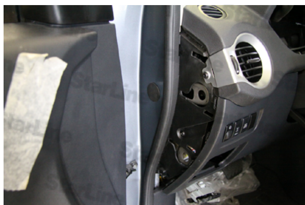
Фото 1.1. Снятие накладки на торпеде
