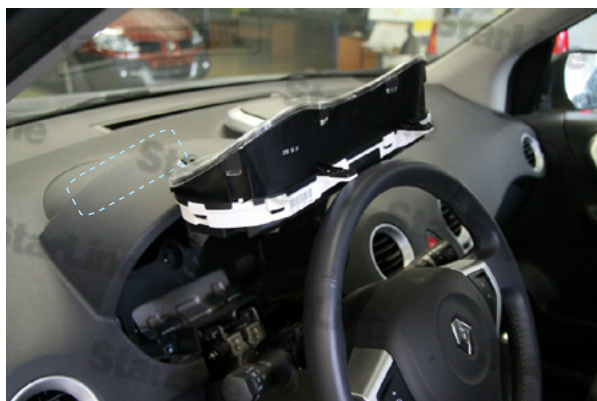
Фото 6. Блок за приборным щитком
