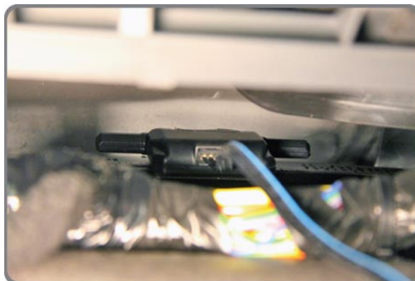
Фото 5.4. Антенный модуль за приборным щитком
