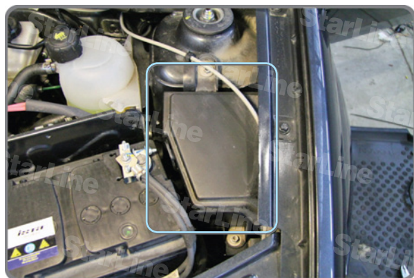
Фото 18.1. Блок реле и предохранителей
