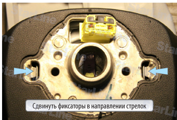
Фото 2.1. Снятие подушки безопасности
