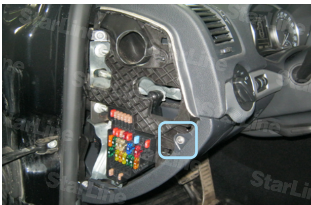
Фото 1.1. Боковая накладка снята. Саморез
