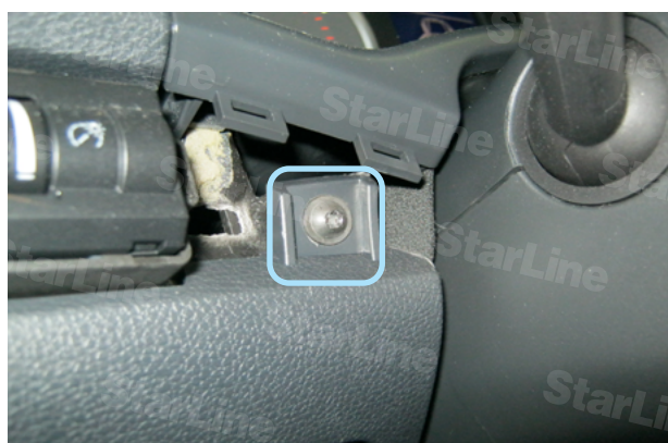
Фото 1.5. Накладка снята. Саморез
