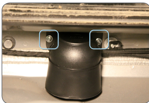
Фото 6.2. Крепление сирены (2 самореза)
