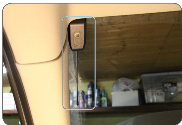
Фото 5.3. Антенна на лобовом стекле
