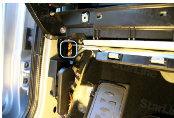
Фото 9.1. Жгут проводов в левой кик-панели
