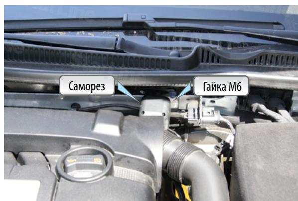
Фото 6.1. Сирена (крепление на саморез и гайку М6)
