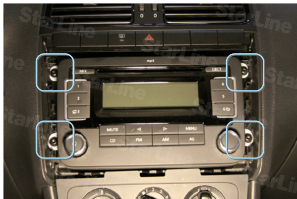
Фото 2.1. Снятие облицовки и саморезы
