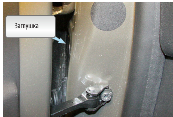
Фото 4.2. Заглушка на левой стойке
