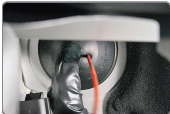
Фото 8.1. Место для прокладывания проводов-вид под капотом
