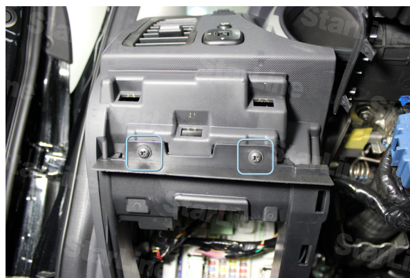
Фото 1.6. Саморезы левой части подторпедника
