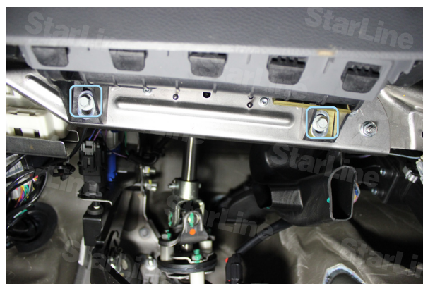
Фото 1.3. Болты крепления airbag
