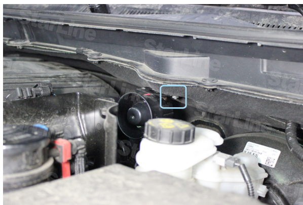
Фото 5.1. Сирена (крепление на гайку М6)
